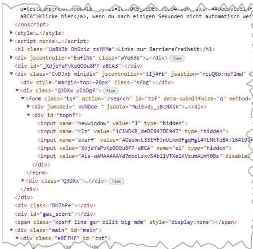
Abb. 2: Der DOM ist hierarchisch aufgebaut
