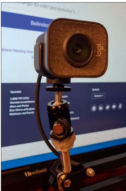
Abb. 10: Schmales Budget: Zur Not gehen auch eine alte Lampenhalterung und ein wenig Heißkleber im Selbstbau
